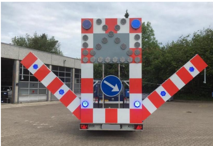
Figur 5.2 Eksempel på afmærkningsvogn med automatiske vinger.
